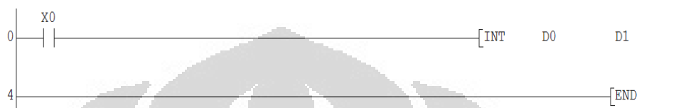
Gambar 2.23 Instruksi konversi nilai format float ke integer [4]
