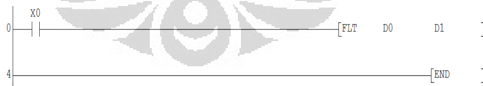
Gambar 2.22 Instruksi konversi nilai format integer ke float [4]
