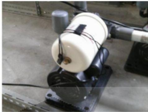
Gambar 3.2 Pompa Sentrifugal
