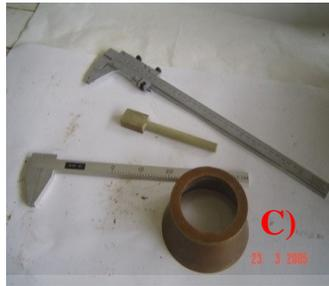
**Gambar 3.2.** Alat Pengujian Konsistensi (FAS)
