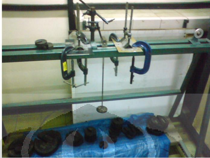
**Gambar 3.4.** Alat Pengujian Lentur Manual
