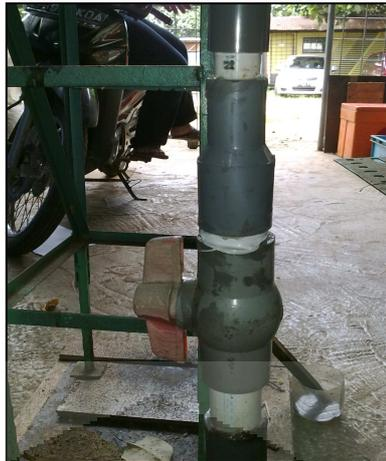
Gambar 4.2 Katup aliran air
