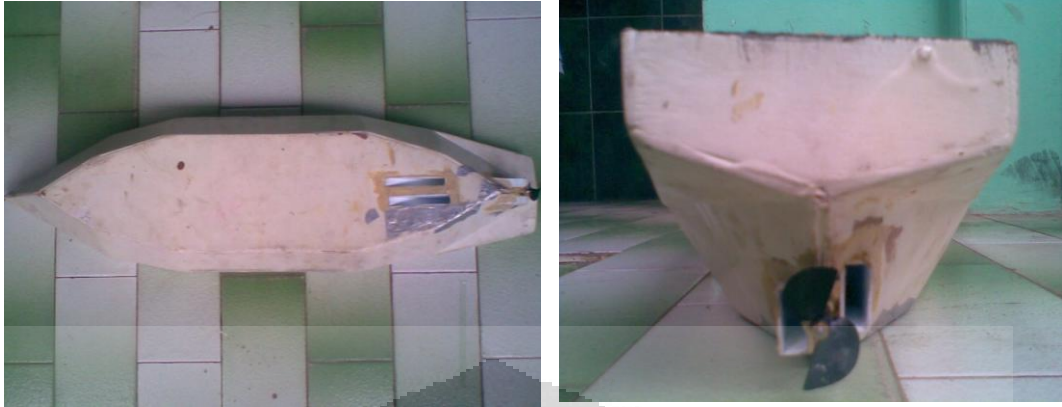
Gambar 3.6 Kapal model dengan water tunnel zigzag tampak bawah dan tampak belakang
