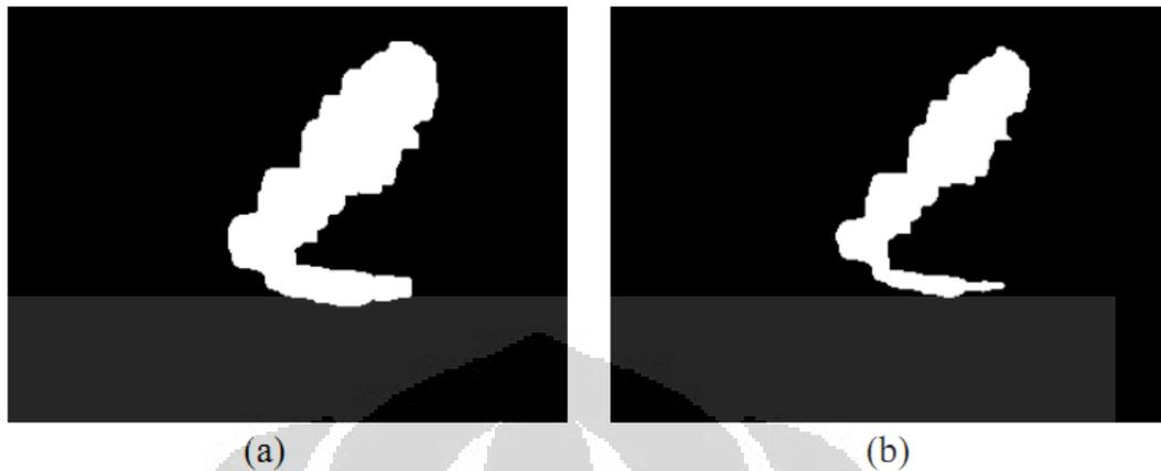
**Gambar 2.16.** Pengolahan citra *blob* (a) *foreground* hasil dilasi setelah *thresholding* (b) *foreground* dilasi setelah dilakukan erosi [8, 9, 24].
