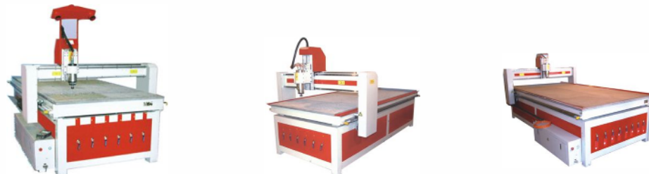
Gb 2.9 Mesin CNC router [10].
