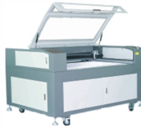
Gb 2.8 Mesin laser engraver [10].
