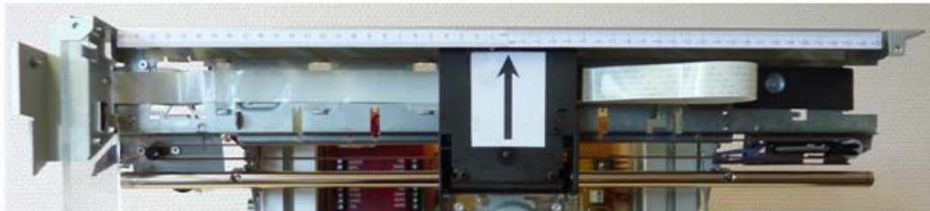
Figure 18. La position de chariot sur le centre du rail/position zéro sur la règle
