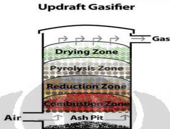
Gambar 2.1 Updraft Gasifier
