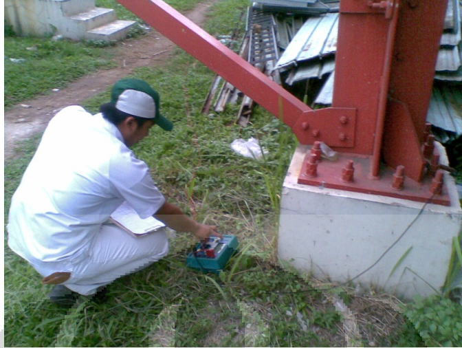
Saat pengukuran resistansi tanah
