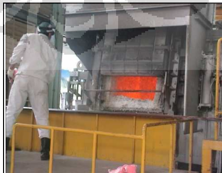
Gambar 2.21 Proses Fluxing Pada Saat Melting
