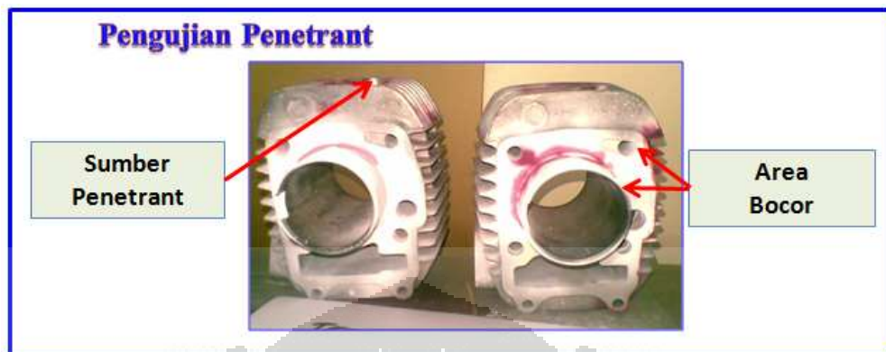
Gambar 3.8 Gambar Tes Penetrant Kebocoran
