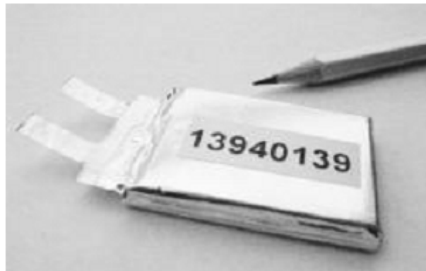
Gambar 2.9. Baterai kantung yang simpel, fleksibel dan ringan. Kapasitas listriknya dibawah baterai konvensional lain, disamping itu biaya produksinya terbilang mahal [9].
