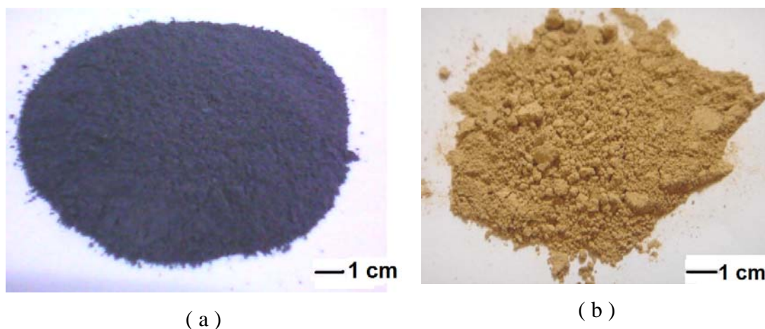
Gambar 4.1. Campuran bahan baku material kathoda \text{Li}_2\text{CO}_3 , \text{TiO}_2 , \text{MnO}_2 , Fe dan \text{H}_3\text{PO}_4 sebelum kalsinasi (a), sesudah kalsinasi pada suhu 700^\circ\text{C} selama 2 jam (b)
