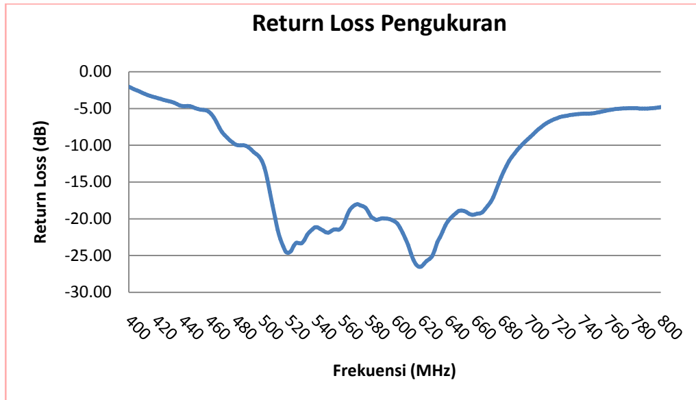
Gambar 4.2 Grafik Return loss Hasil Pengukuran Antena
