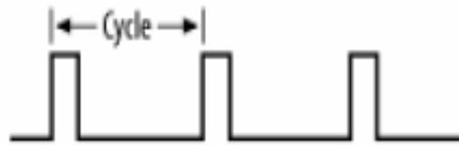
Gambar 2.9 Contoh PWM dengan duty cycle 10% [12].
