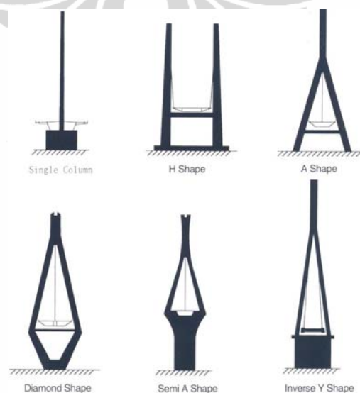
Gambar 2.6 Bentuk Dasar Pylon Jembatan Cable Stayed
