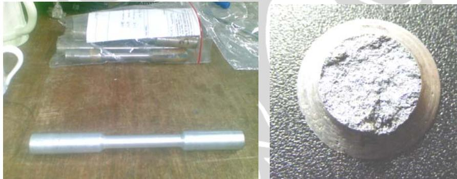
Gambar 3.29 Sampel uji tarik dan hasil patahan uji tarik
