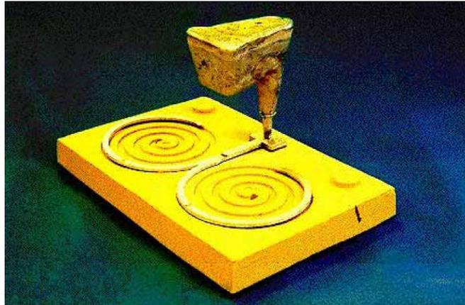
Gambar 1.1 Perlatan original alat uji fluiditas spiral gravitasi[3]
