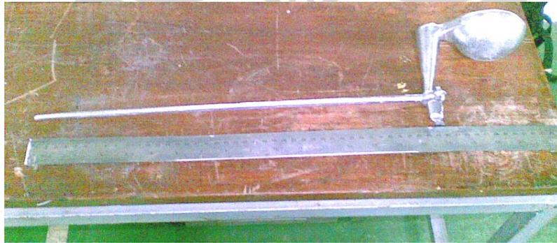
Gambar 3.22 Proses pengukuran hasil alat uji fluiditas.
