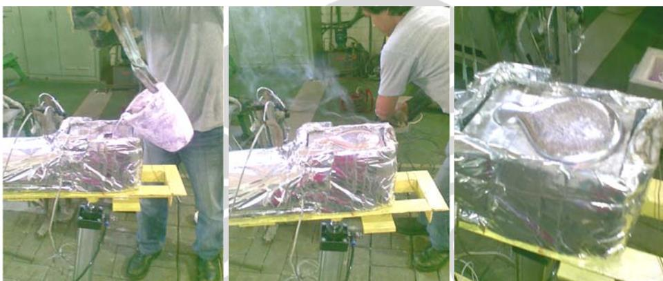
Gambar 3.20 Proses Penuangan cairan logam ke alat uji fluiditas
