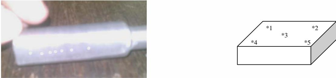
Gambar 3.26. Daerah bekas penetrator pada sampel
