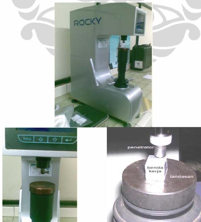
Gambar 3.25. Mesin uji Rockwell dengan benda kerja.
