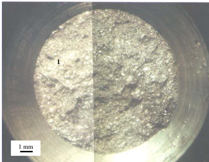
Gambar 4.6 Foto mikrostruktur sampel bekas patahan pengujian tarik (perbesaran 7x)
