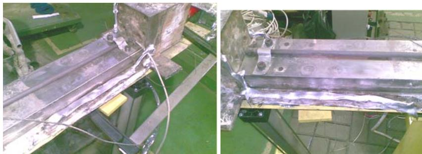
Gambar 4.10 Terjadi *splashing* pada pengujian nilai fluiditas kecepatan pemiringan tinggi (42 mm/s)
