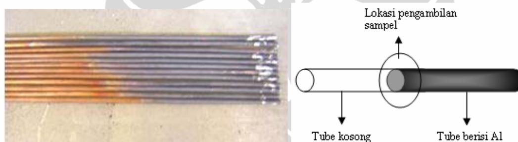
Gambar 3.4 Hasil pengujian fluiditas vakum
