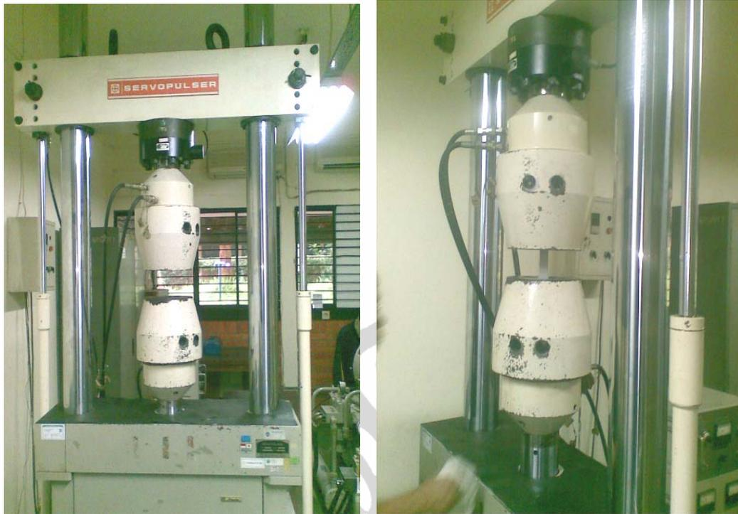
Gambar 3.28 Proses pengujian tarik
