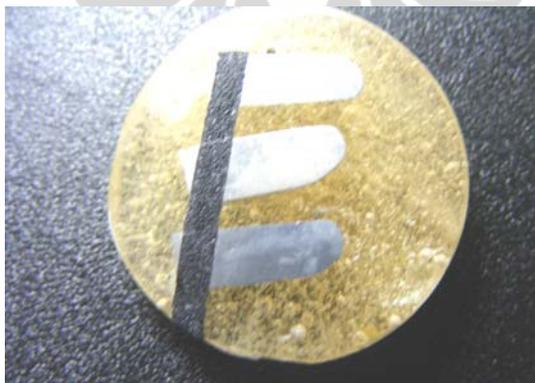
Gambar 3.33 Sampel hasil alat uji fluiditas setelah dilakukan mounting
