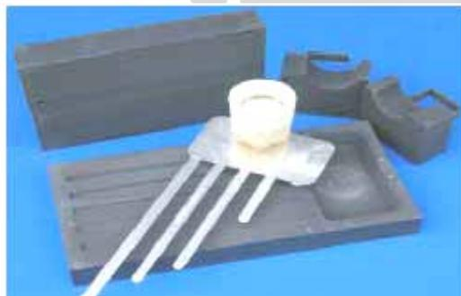
Gambar 38 b) Cetakan yang terbuka dan sampel dari test fluiditas [20]
