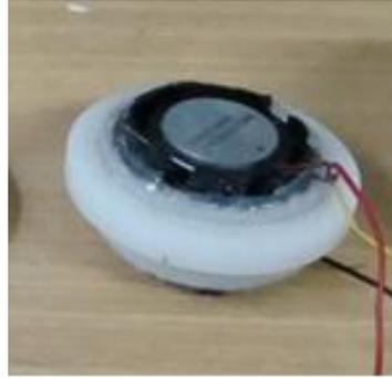
Gambar 3.2 Model fisik *synthetic jet* (dalam cm) (a) Susunan aktuator *synthetic jet* dengan *heat sink* (b) Detail aktuator *synthetic jet* (c) memperlihatkan *prototype* yang telah terintegrasi dengan jet sintetik
