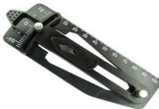
Gambar 3.5 Pitch gauge dengan besaran sudut -10^{\circ} sampai +10^{\circ}
