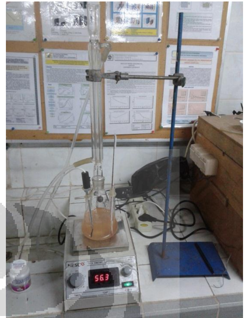
Gambar 3.2. Susunan Perangkat Kondenser
