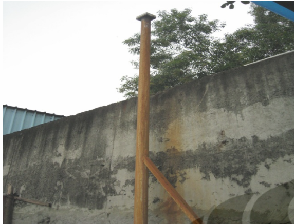
Pipa pembuangan gas sisa emisi CO 2 yang tidak masuk ke dalam kolam percobaan
