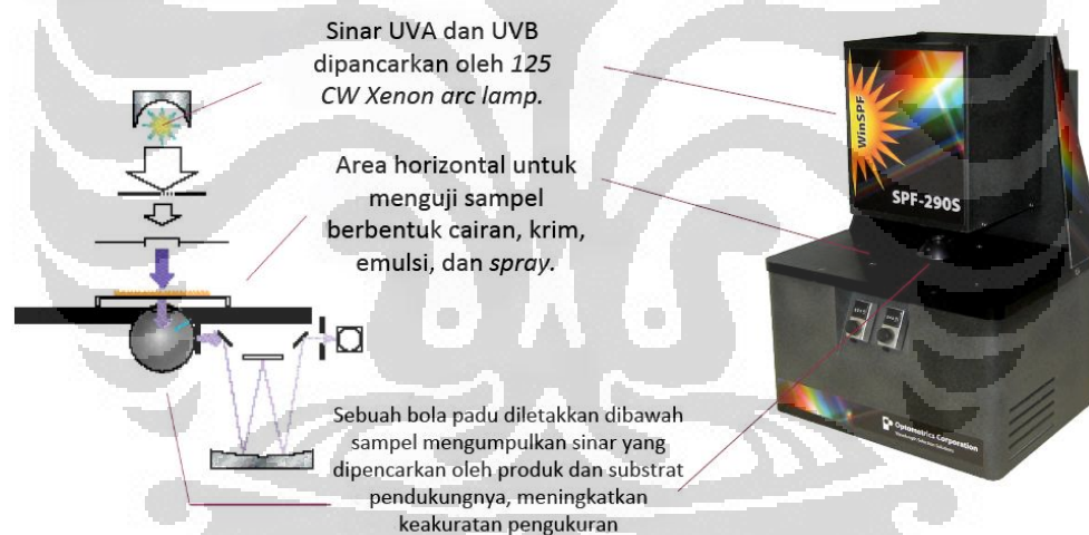
Gambar 3. 4. Mekanisme Kerja Alat Optometric 290s
