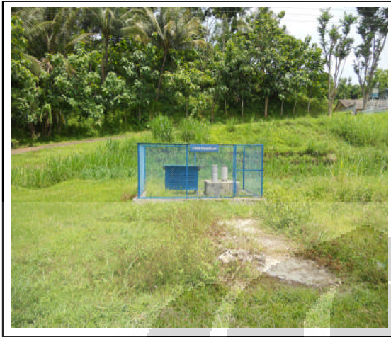
Foto 1. Stasiun Pengamat Curah Hujan Bendung Pejengkolan. (Salah Satu Stasiun Pengamat Curah Hujan di Pegunungan)
