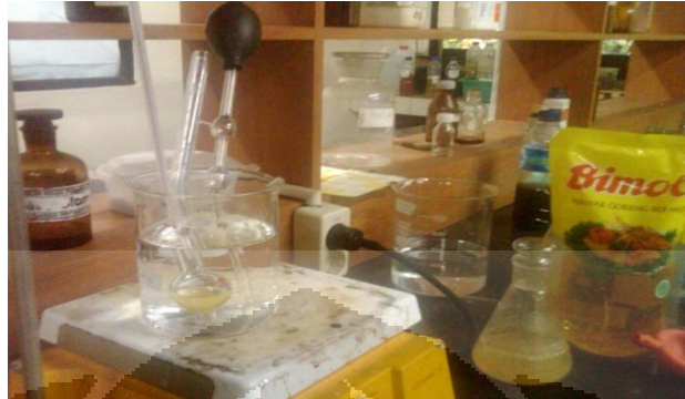
Gambar 4.7 uji viskositas sampel biodiesel menggunakan viscometer Oswald pada suhu 40°C
