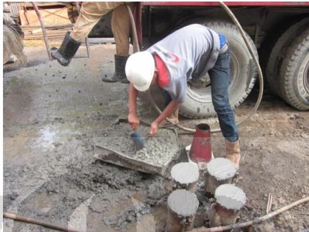
Gambar 4.9 Pengambilan Sampel *Mix* Beton Untuk Pengecekan *Slump*
