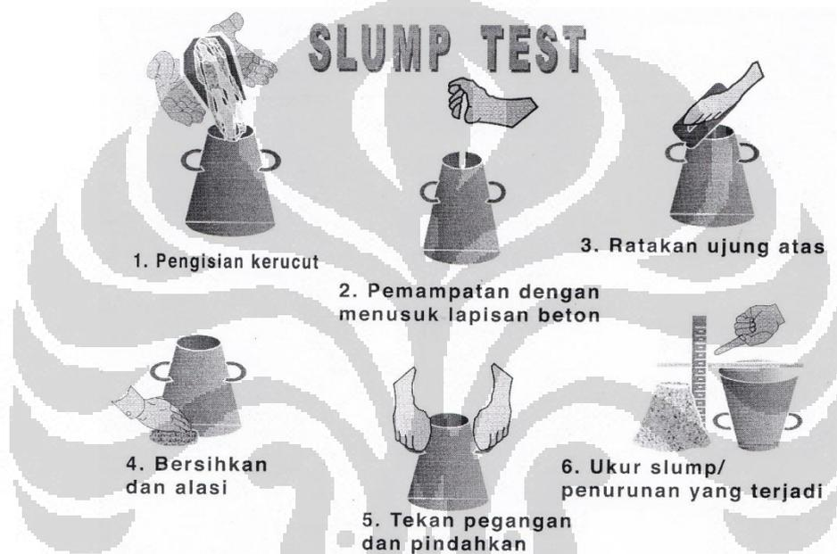
Gambar 2.7 Langkah-langkah *Slump Test*
