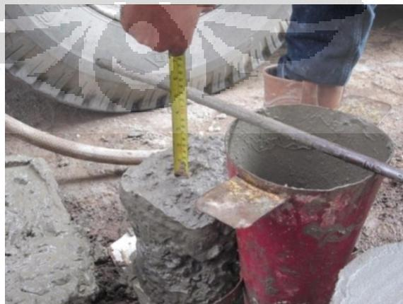
Gambar 4.11 Pengukuran *Slump* Beton K400 ± 12
