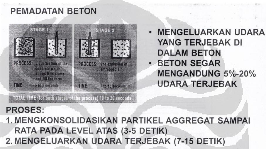
Gambar 2.13 Proses Pemadatan Beton
