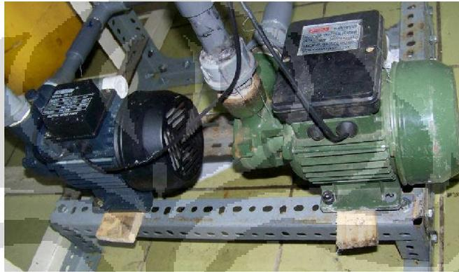
Gambar 3.5. Pompa sentrifugal
