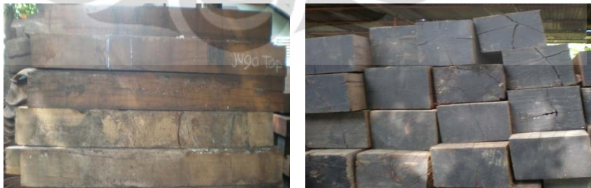
Gambar 2.14 Balok bantalan kayu
