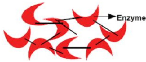
Gambar 2-17. Metode Imobilisasi Enzim dengan Cross-linking (Elnashar, 2009)
