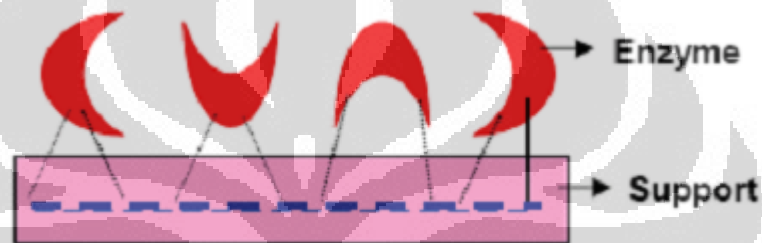
Gambar 2-9. Metode Imobilisasi Enzim dengan Metode Adsorpsi (Elnashar, 2009)
