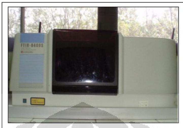
**Gambar 3.3.** Spektrofotometer infra merah FTIR 8400S (Shimadzu)
