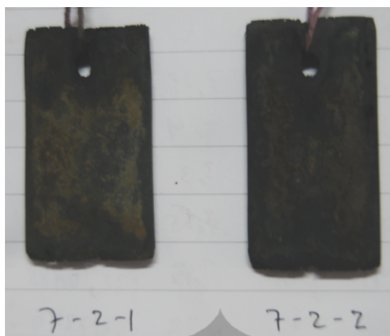
Gambar 4.9 Foto sampel setelah perendaman 7 hari pada larutan 0.5M H 2 SO 4 dengan 2000ppm inhibitor ekstrak daun kenikir
