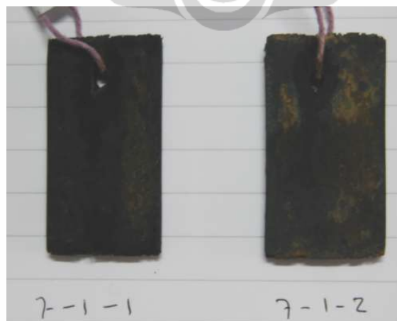
Gambar 4.8 Foto sampel setelah perendaman 7 hari pada larutan 0.5M H 2 SO 4 dengan 1000ppm inhibitor ekstrak daun kenikir
