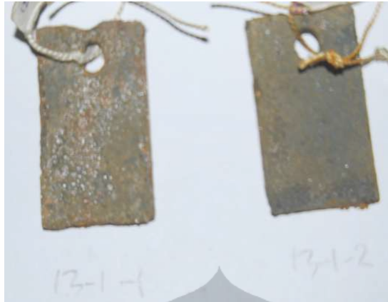
Gambar 4.18 Foto sampel setelah perendaman 13 hari pada larutan 0.5M H 2 SO 4 dengan 1000ppm inhibitor ekstrak daun kenikir
