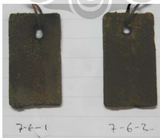
Gambar 4.11 Foto sampel setelah perendaman 7 hari pada larutan 0.5M H 2 SO 4 dengan 6000ppm inhibitor ekstrak daun kenikir
