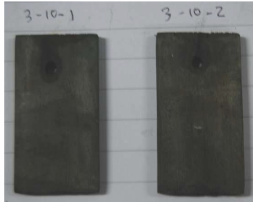
Gambar 4.3 Foto sampel setelah perendaman 3 hari pada larutan 0.5M H_2SO_4 dengan 1000ppm inhibitor ekstrak daun kenikir
