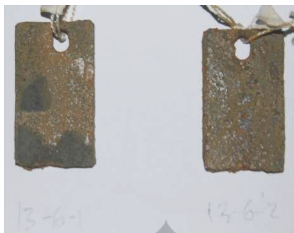
Gambar 4.21 Foto sampel setelah perendaman 13 hari pada larutan 0.5M H 2 SO 4 dengan 6000ppm inhibitor ekstrak daun kenikir
