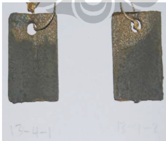
Gambar 4.20 Foto sampel setelah perendaman 13 hari pada larutan 0.5M H 2 SO 4 dengan 4000ppm inhibitor ekstrak daun kenikir
