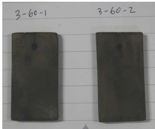
Gambar 4.6 Foto sampel setelah perendaman 3 hari pada larutan 0.5M H 2 SO 4 dengan 6000ppm inhibitor ekstrak daun kenikir
