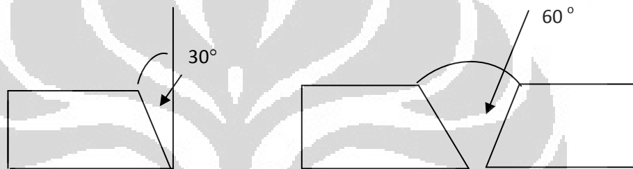
Gambar 3. 2 Potongan sebelum pengelasan(kiri), Bentuk sambungan saat pengelasan (kanan)
