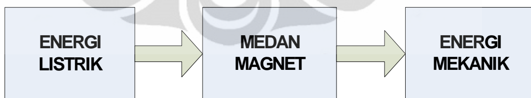
Gambar 2.6 Proses Konversi Energi pada Motor DC
