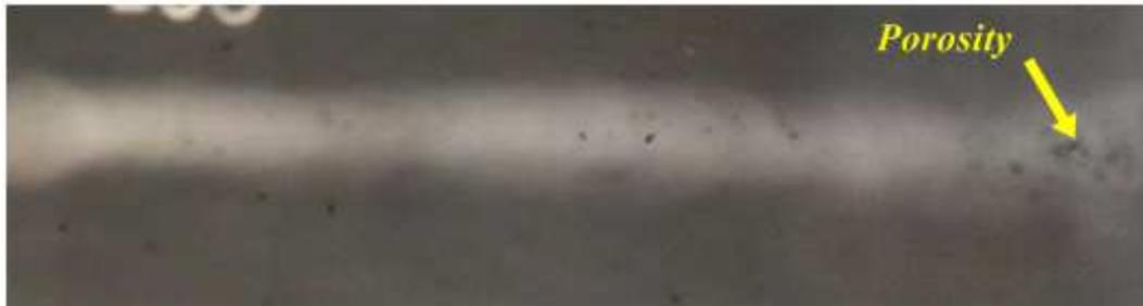
**Gambar 4. 5** Foto Radiografi Sampel Pengelasan dengan Elektroda E 7018;
