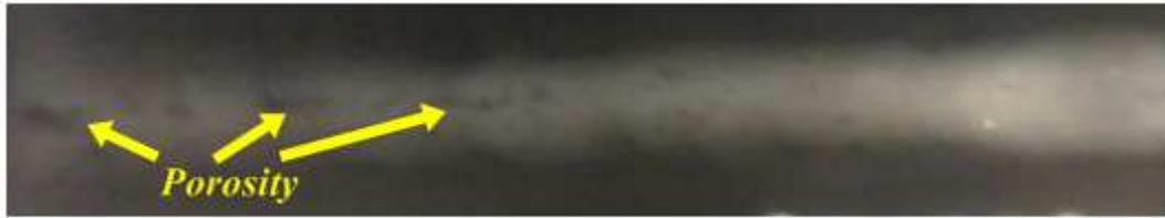
**Gambar 4. 4** Foto Radiografi Sampel Pengelasan dengan Elektroda MG NOX 35; *Preheat* 150<sup>0</sup>C
