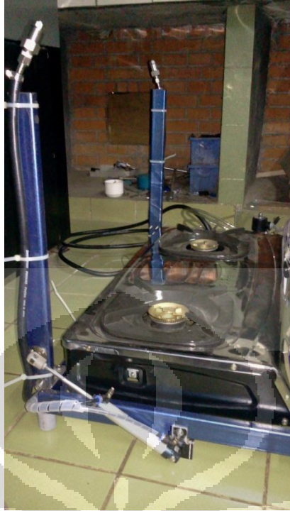
Gambar 3.2 Hasil rancangan rangka dudukan nozzle kabut air
