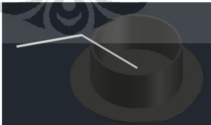
Gambar 3.29 Posisi termokopel di dalam minyak goreng
