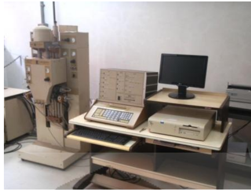
Gambar 3.5. Alat pengujian Thermogravimetry (TG)
