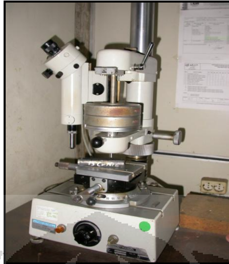
Gambar 3. 11 Alat Uji Vickers Frank Finotest (Laboratorium Metalurgi PT Krakatau Steel, Cilegon)
