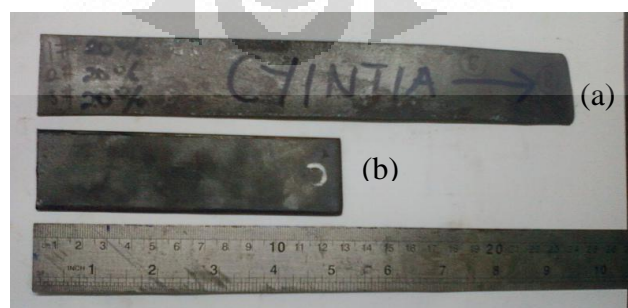
Gambar 4. 1 Foto Benda Uji Bebas Interstisi ( IF Steels ) (a) Yang Telah Dideformasi dan (b) Awal (Belum Dideformasi)
