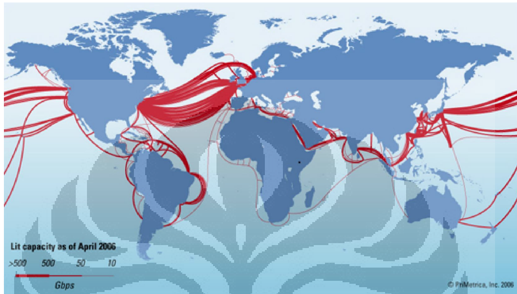
Gambar 2.1 Sistim jaringan komunikasi fiber optik bawah laut internasional.
