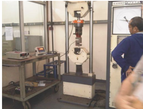
Gambar 3. 27. Proses Kalibrasi Load Cell dan Display Indicator
