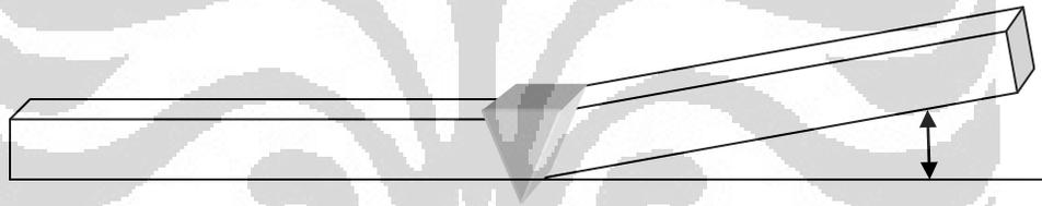
**Gambar 3.3.** Ilustrasi pengukuran distorsi angular
