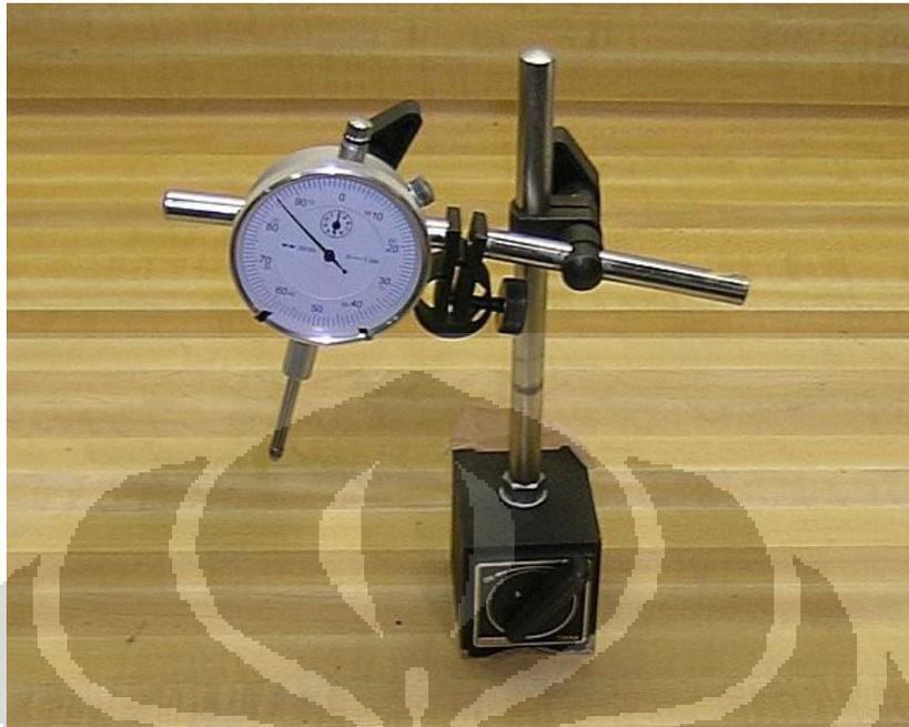
**Gambar 3.2.** Dial Gauge untuk pengukuran distorsi
