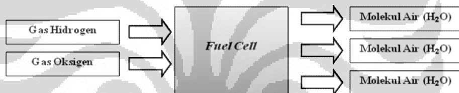
Gambar 2.1 Skema Input dan Output Fuel Cell [5]
