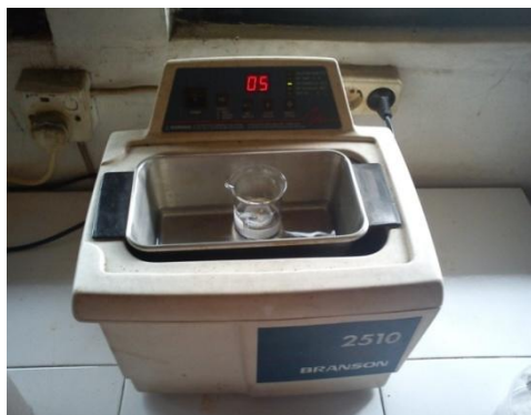
Gambar 4.8 Pembersihan elektroda glassy carbon secara fisika dengan sonicator Branson 2510
