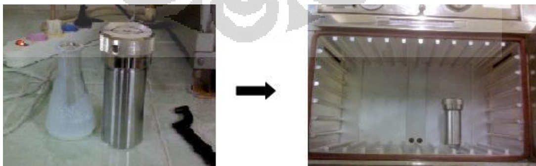
Gambar 4. 2 Hidrotermal larutan milky suspension setelah dituangkan di dalam oven
