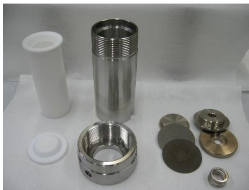
Gambar 3. 4 Skematis dari bagian-bagian dari autoclave , dan (kiri) gambaran dari pemasangan Teflon vessel [75]
