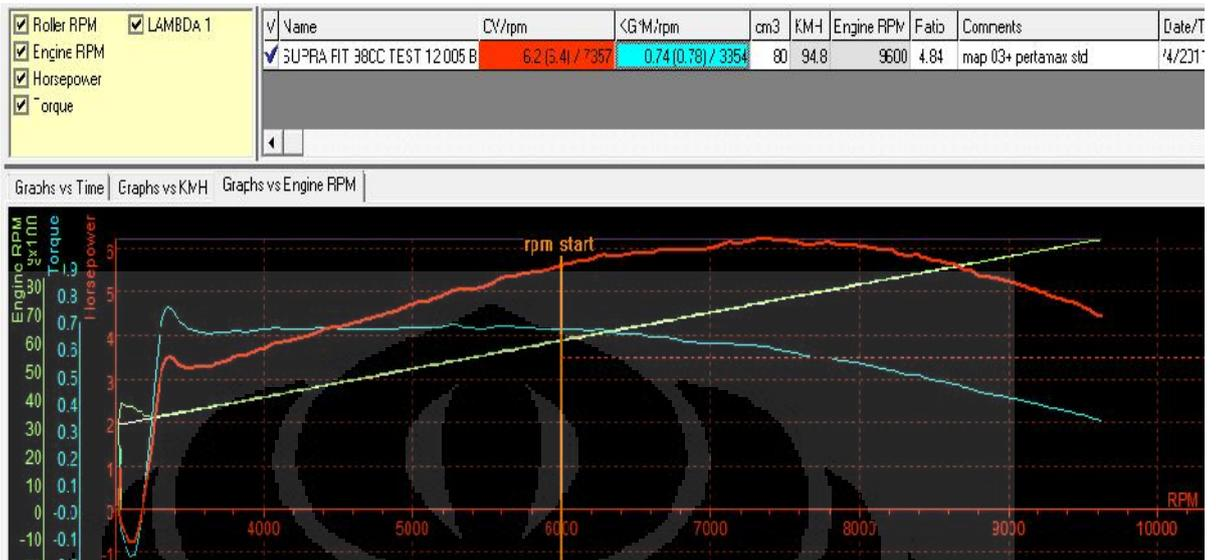
Gambar 4.31 Grafik BHP dan Torsi Map 3 Tanpa Gas Hidrogen Pertamax
