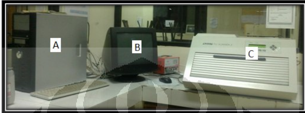
Gambar alat TLC scanner dan komputer yang dilengkapi dengan program wincats . A: CPU; B: layar komputer; C: Camag TLC Scanner 3 .
