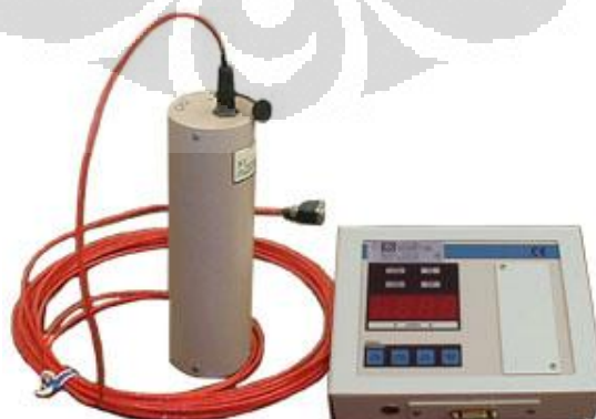
Gambar 3.7. Detektor dan Monitor Radiasi Ludlum 375/2 [14]
