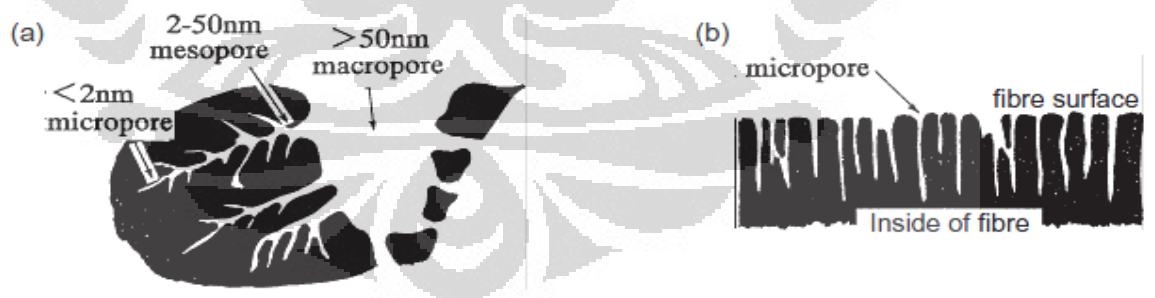
Gambar 2.2 Struktur pori dari karbon aktif : (a) granular, (b) serat
