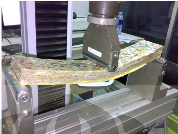
Gambar 4.31. Uji lentur dan modulus elastisitas
