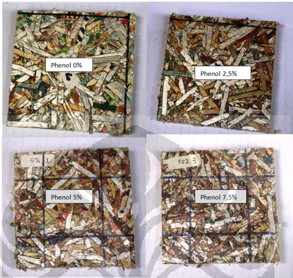
Gambar 4.3 Benda uji papan komposit aseptik
