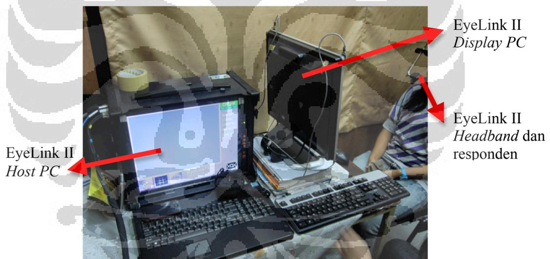
**Gambar 3.16.** Susunan Peralatan yang Dibutuhkan
