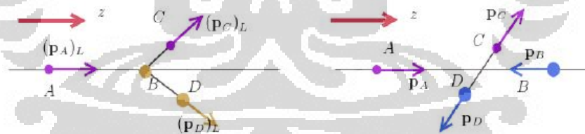
Gambar 2.1: Proses kinematika tumbukan elastik dua benda
