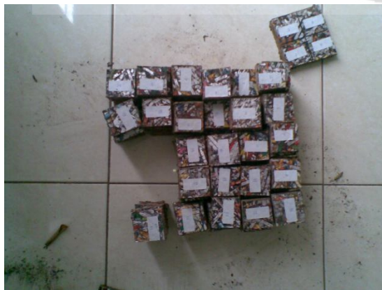
Hasil pemotongan benda uji untuk pengujian daya serap dan pengembangan tebal
