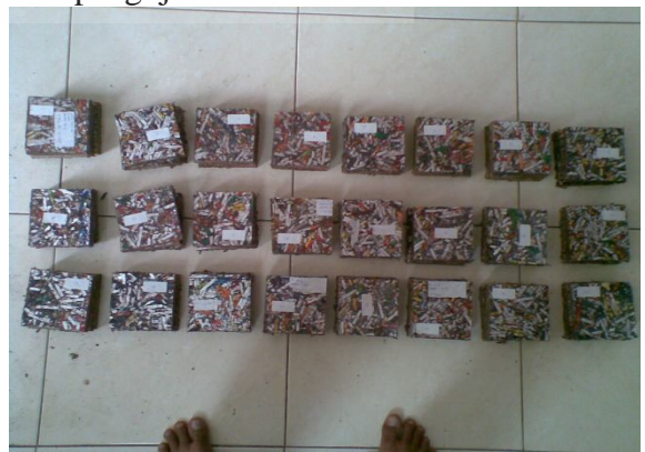
Hasil pemotongan benda uji untuk pengujian visual kerapatan dan kadar air
